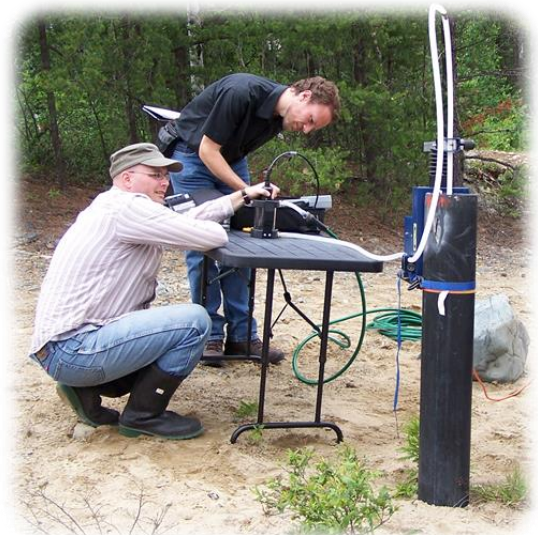
Figure 1 : Échantillonnage de l'eau souterraine à l'aide d'un piézomètre (SESAT, 2010)
